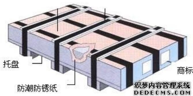
防锈纸: 牛皮纸上涂上 VCI LIQUID 产品,防锈纸包装后又使用了如下所示防潮纸。
